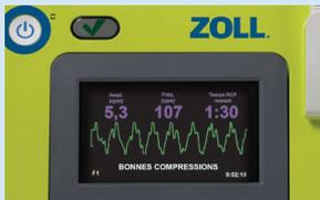
Le tableau de bord CPR Dashboard™ de ZOLL fournit une évaluation en temps réel de la profondeur, la fréquence et la durée du cycle de la RCP sous forme numérique.
